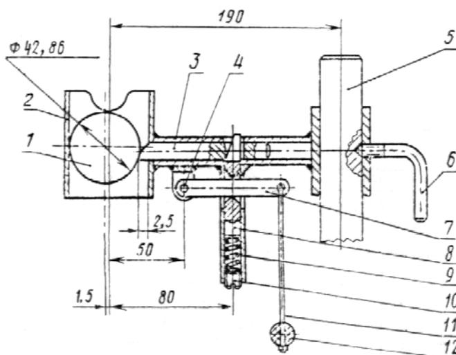
1 — шарик; 2 — кронштейн; 3 — плунжер; 4 — ось; 5 — штанга; 6 — фиксатор;
