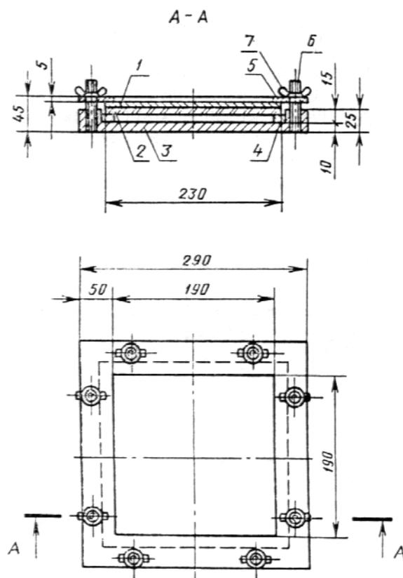
1 — образец; 2 — плита древесностружечная; 3 — основание металлическое;
